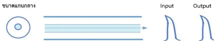
ภาพที่ 4.12 แสดงสายใยแก้วนำแสง Singlemode
