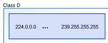
ภาพที่ 10.8 แสดงหมายเลข IP address ในคลาสดี
