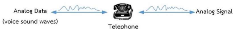
ภาพที่ 3.13 การแปลงเสียงพูดให้เป็นสัญญาณแอนะล็อกผ่านโทรศัพท์แบบพื้นฐาน ที่มา : (โอภาส เอี่ยมสิริวงศ์, 2559, หน้า 170)
